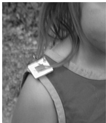
Figur 6. Polysulfonfilm dosimeter på ett barn.
